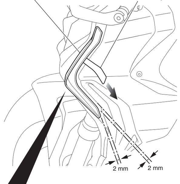
Installez le déflecteur en suivant l'extrémité de la bande de la moto, afin d'être bien parallèle.
